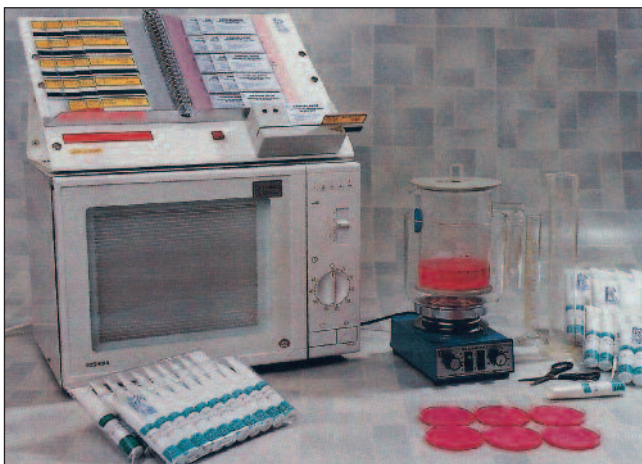
FIGURE 18 - LE FOUR À MICROONDES KORANO Avec le lecteur de cartes magnétiques, le flacon de préparation des milieux, les doses de milieux de culture.
